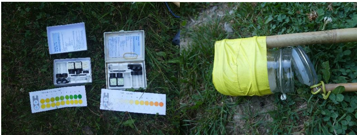
Abbildung 7: Testsätze zur Messung von Ammonium und Nitrat
