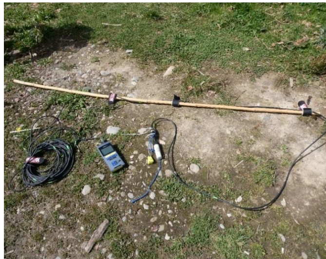
Abbildung 6: Oxi 3205 mit Messkonstruktion
